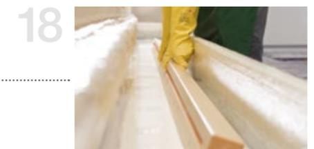
18 Пропитывающий состав деревянных деталей обеспечивает их долговечность, высокое качество и оптимальную защиту всех граней.
