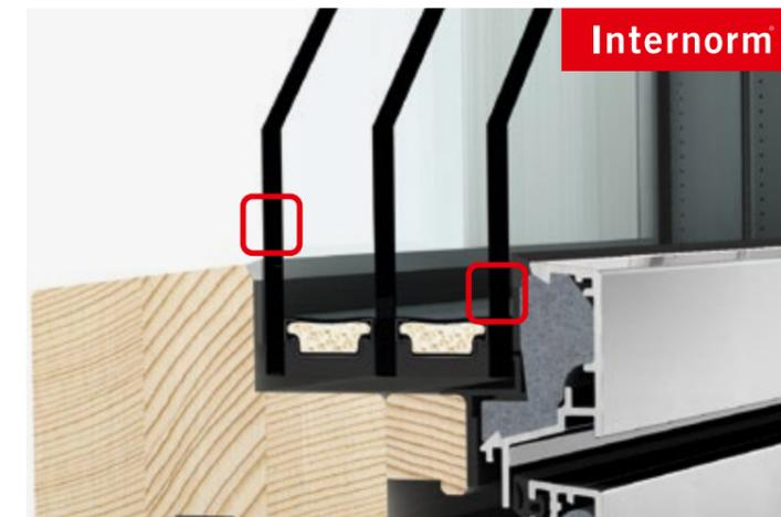
Остекление со стороны помещения герметично, поэтому влажный воздух из помещения не проникает внутрь конструкции и не повреждает древесину.
