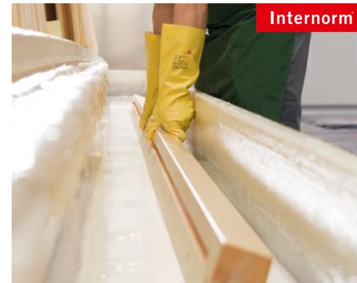
При пропитывании рамы целиком, отсутствует защита в местах соединения.
